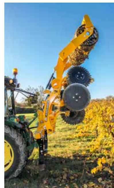
Les déchaumeurs à disques Disc-O-Vigne permettent d'entrer dans le sol sur une dizaine de centimètres.
